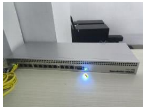
Gambar 5. Router Distribusi di Lab.
